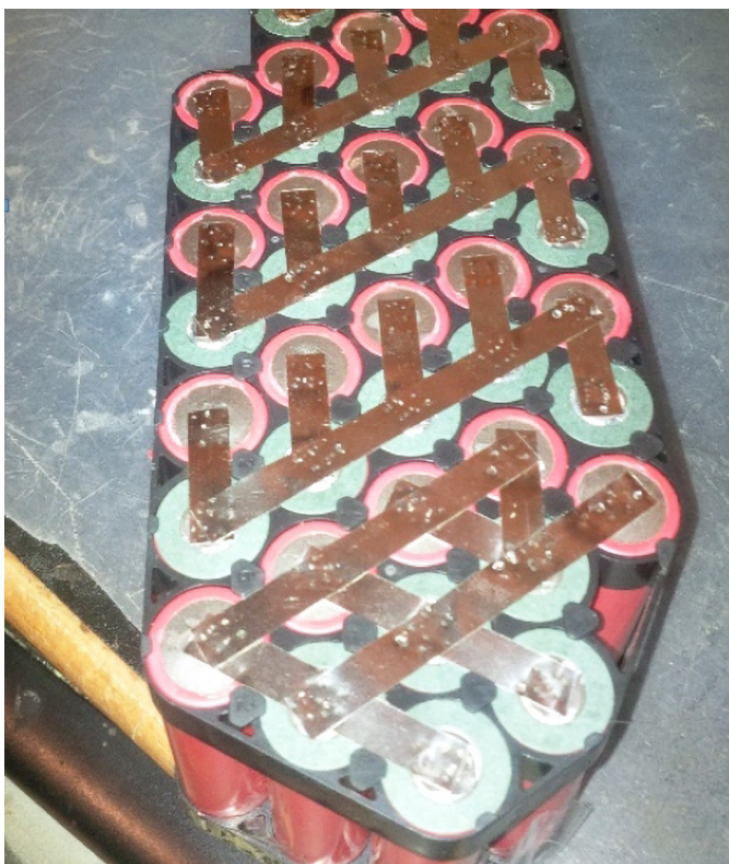
Fotografia 4. Gotowy zgrzany pakiet ogniw
