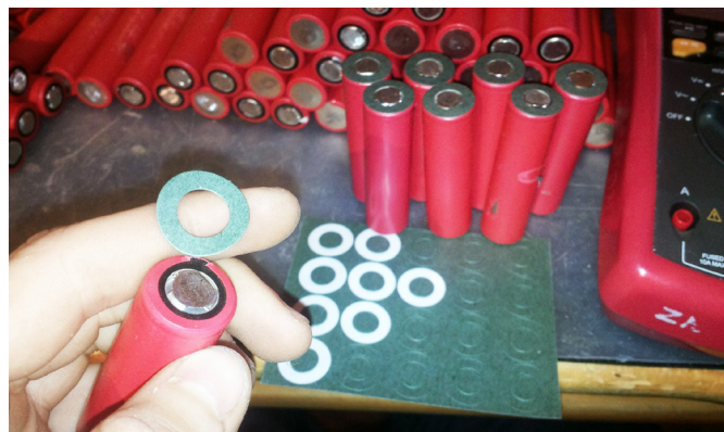
Fotografia 1. Przyklejanie izolatorów do ogniw
