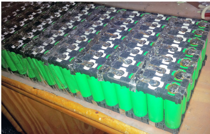
Fotografia 3. Gotowy zlutowany pakiet ogniw
