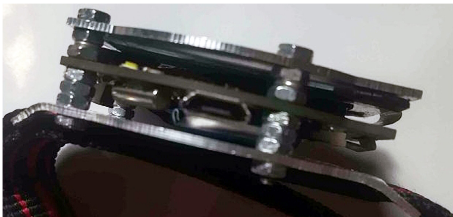
Fotografia 4. Sposób przykręcenia płytek
