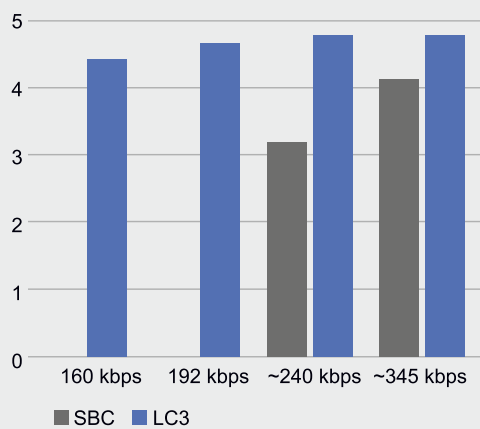
Rysunek 3. Testy odsłuchu dźwięku z kodowaniem SBC oraz LC3 [3]
