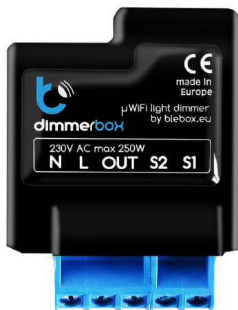
Fotografia 4. Moduł ściemniacza oświetlenia sterowany przez Wi-Fi
