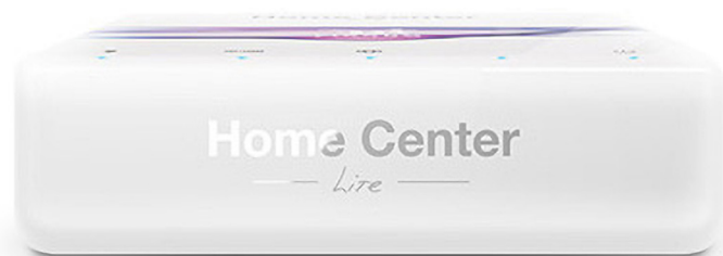
Fotografia 14. Centralka bezprzewodowa – Gateway dla urządzeń smart home
