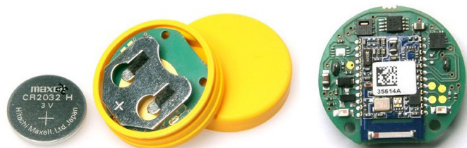
Fotografia 8. Bezprzewodowy czujnik parametrów powietrza
