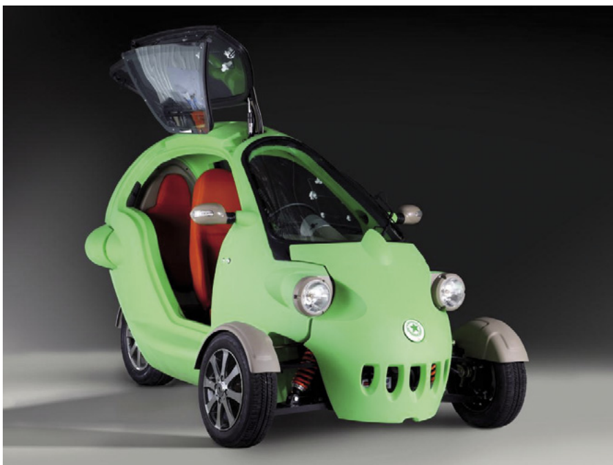
Fot. 1. Pojazd elektryczny Re-Volt, zasilany pakietami firmy Wamtechnik z ogniwami Kokam o łącznej pojemności ok. 7 kWh, napięciu (bez obciążenia) 133 V, wydajności prądowej na poziomie 150 A i o dopuszczalnym prądzie maksymalnym 250 A
