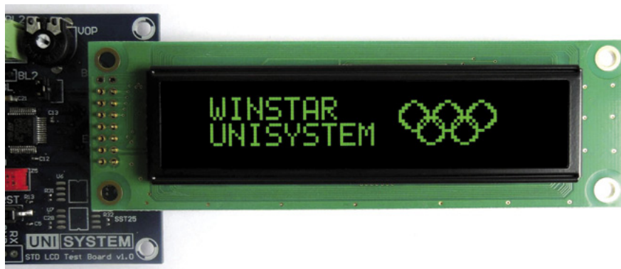
Fotografia 3. Wyświetlacz WEG010016FG pracujący w trybie graficznym
