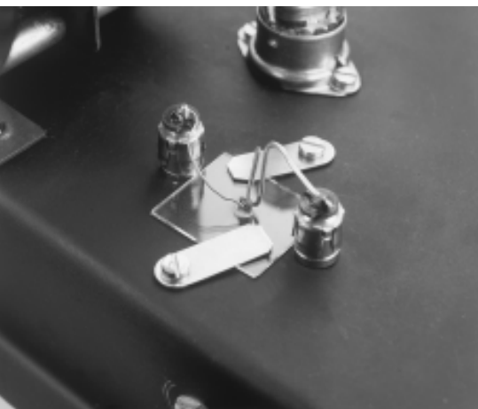
Fot. 4. Budowa detektora kryształkowego zastosowanego w odbiorniku
