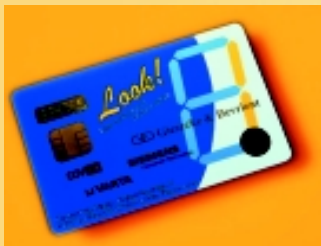
Fot. 4. Karty płatnicze ze świecącymi wyświetlaczami zrobionymi z organicznych LED-ów
