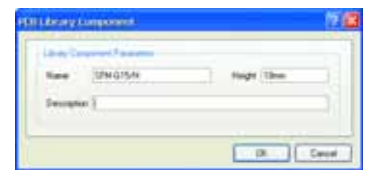
Rys. 11. Wysokość każdego podzespołu możemy określić bezpośrednio na płycie lub też na poziomie biblioteki elementów
