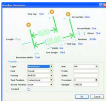
Rys. 8. Wymiary w Protelu DXP są skojarzone z wymiarowanym obiektem
