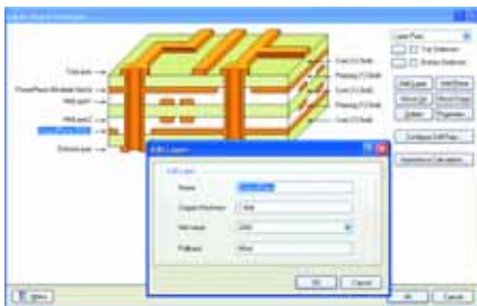
Rys. 1. Szerokość strefy pullback możemy określić dla każdej warstwy niezależnie w okienku Layer Stack Manager
