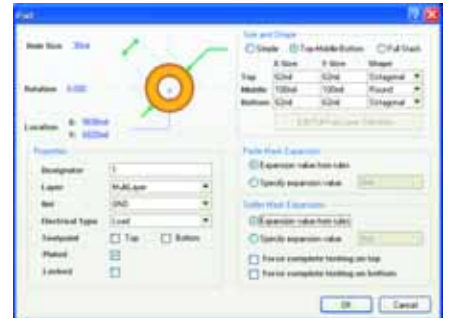
Rys. 10. Wszystkie dostępne parametry pól lutowniczych można modyfikować w przedstawionym oknie
