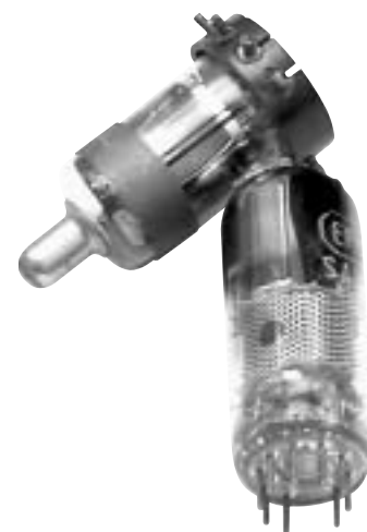
Fot. 1. Porównanie wojskowej lampy RV12P2000 z popularną pentodą EF80
