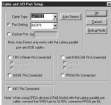
Rys. 12. Podczas programowania układów PLD, ispPAC i ispGDX firmy Lattice za pomocą programu ispVM System należy wybrać opcję Lattice w oknie selekcji Cable Type
