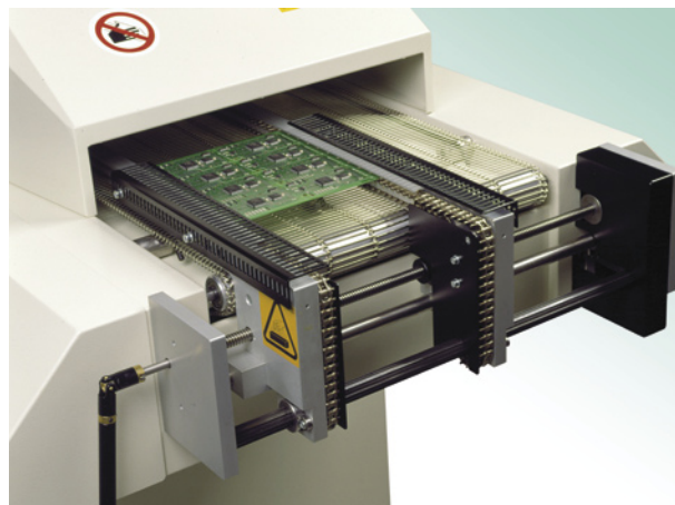
Fot. 1. Transporter łańcuchowy „niosący” lutowaną płytkę drukowaną
