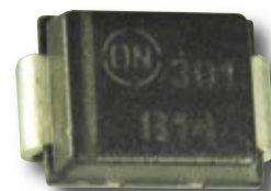
Fot. 20. Dioda w obudowie DO-214AA (SMB)
