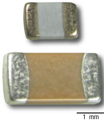
Fot. 11. Kondensatory ceramiczne MLCC w obudowach 0805 i 1206
