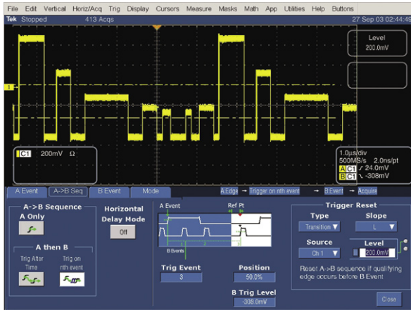
Rys. 21. Pinpoint: wyzwalanie określone sekwencją zdarzeń wraz z warunkiem ją kasującym
