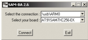
Rys. 4. Okno wyboru mikrokontrolera przy starcie programu SAM-BA
