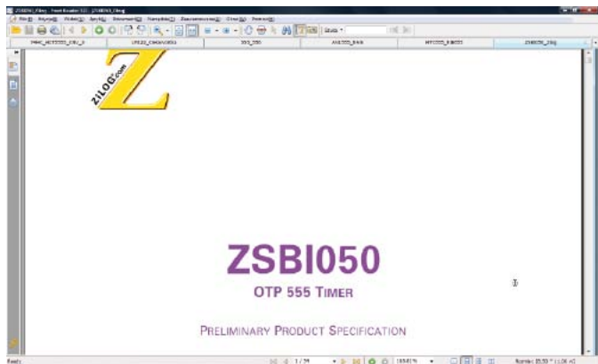
Rys. 7. Strona tytułowa noty katalogowej timera ZSBI050 firmy Zilog, który jest dalekim krewnym analogowej wersji 555
