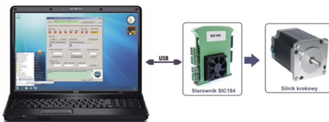
Rysunek 10. Diagnostowanie i sterowanie silnikiem bezpośrednio z komputera PC
