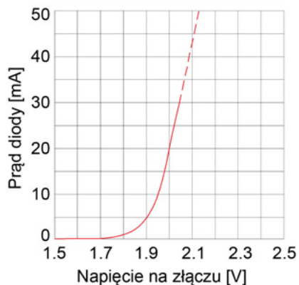
Rysunek 1. Charakterystyka prądowo-napięciowa diody LED
