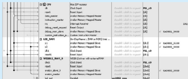
Rysunek 13. Kluczowe połączenia nowego modułu i przeznaczonej dla niego 2-portowej pamięci RAM
