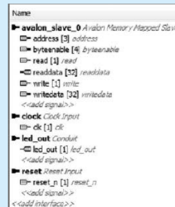
Rysunek 6. Sygnały i ich funkcje w module WS2812
