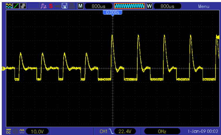
Rysunek 5. Przebieg czasowy napięcia na zaciskach przetwornika piezo
