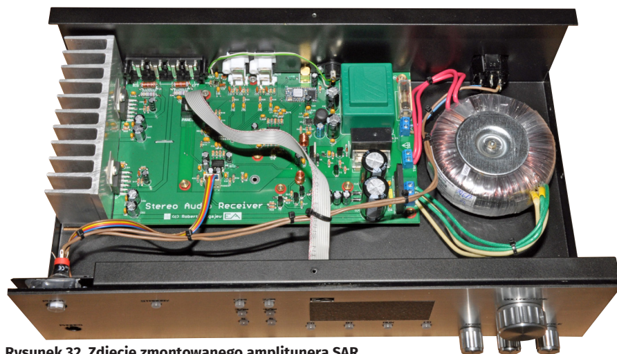
Rysunek 32. Zdjęcie zmontowanego amplitunera SAR
