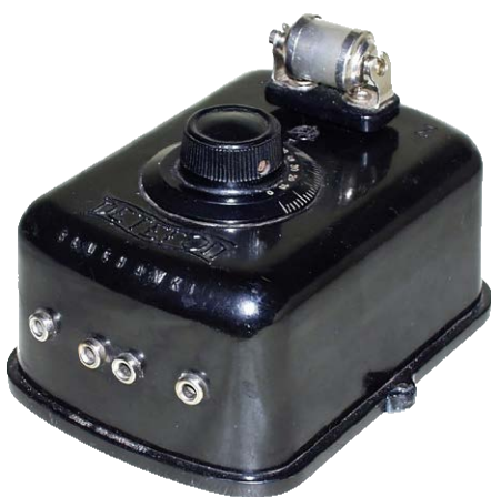
Fotografia 1. Detefon (1929 r.) – pierwszy polski radioodbiornik kryształkowy produkowany przez Państwową Wytwórnę Łączności
