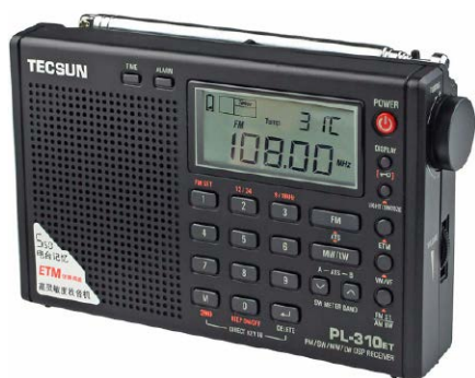
Fotografia 14. Odbiornik globalny Tecsun PL310 z układem Si4734 umożliwia odbiór częstotliwości: FM: 64–108 MHz (stereo); MW: 522–1620 kHz (wybór kroku 9 kHz lub 10 kHz); LW: 153–513 kHz; SW: 2300–21 950 kHz
