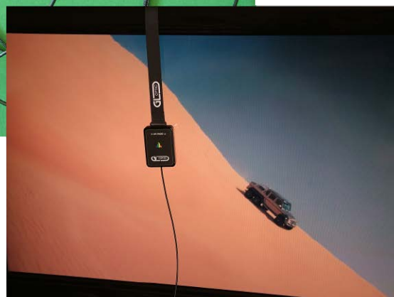
Fotografia 3. Sonda GL OPTI PROBE z ciężarkiem stanowiącym przeciwwagę do mocowania na ekranie przeznaczona do pomiaru luminancji m.in. płaskich ekranów LCD
