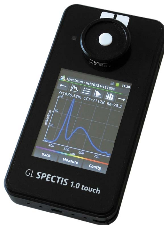
Fotografia 1. Spektrometr GL Spectis 1.0 Touch z funkcją pomiaru tętnienia światła (Flicker)
