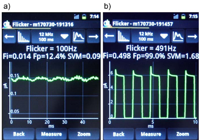
Fotografia 8. Pomiar tętnienia: a) lampy oświetleniowej LED, b) latarki tzw. czółówki
