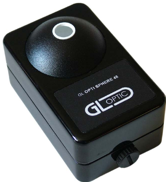
Fotografia 2. Miniaturowa kula całkująca do pomiaru strumienia świetlnego diod LED
