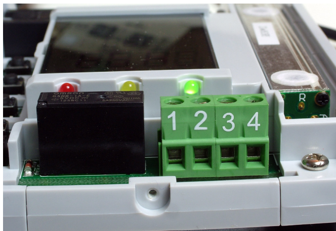
Fotografia 1. Listwa zaciskowa zawierająca wyprowadzenia styków przekaźnika oraz zaciski zasilania zewnętrznego
