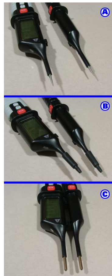
Fotografia 3. Konfiguracje końcówek pomiarowych testera VC-64, a) końcówki stożkowe, b) plastikowe nakładki do pomiarów CAT III i CAT IV, c) końcówki do pomiarów w gniazdach zasilających
