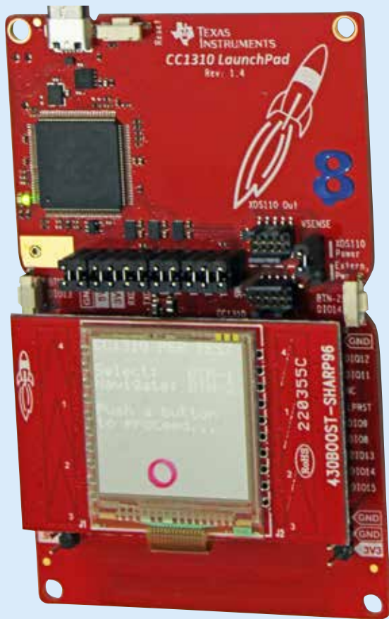
Rysunek 2. Zestaw CC1310 LaunchPad z dołączonym modułem LCD
