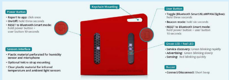
Rysunek 1. Zestaw CC2650 SensorTag w obudowie plastikowej i pokrowcu silikonowym [7]
