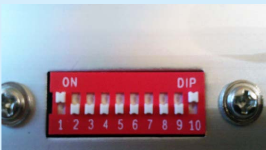
Fotografia 9. Przelicznik DIP SWITCH służący do ustawiania adresu
