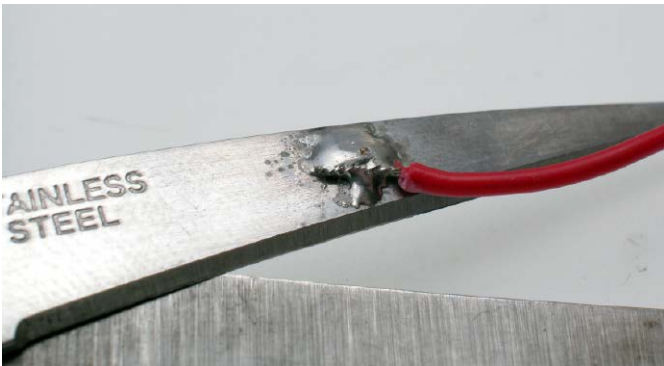
Fotografia 2. Przewód miedziany przylutowany do... nożyczek za pomocą STS-10
