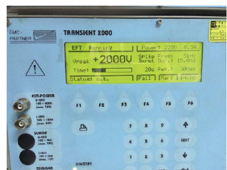
Fotografia 5. Konfiguracja aparatury testującej zgodność z normą IEC 61000-4-4
