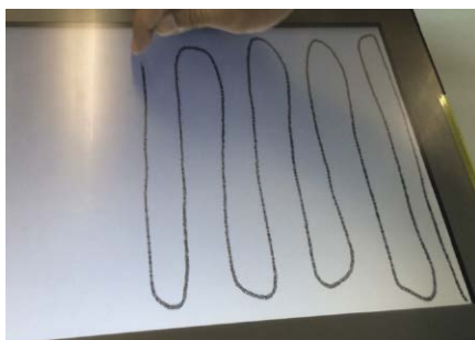
Fotografia 9. Praca ekranu z kontrolerem PM1710 w trakcie testu zgodności z normą IEC61000-4-6
