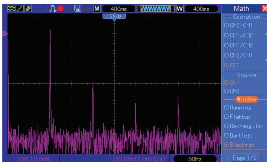
Rysunek 4. Widmo amplitudowe (w skali decybelowej) pojedynczego przebiegu wyjściowego
