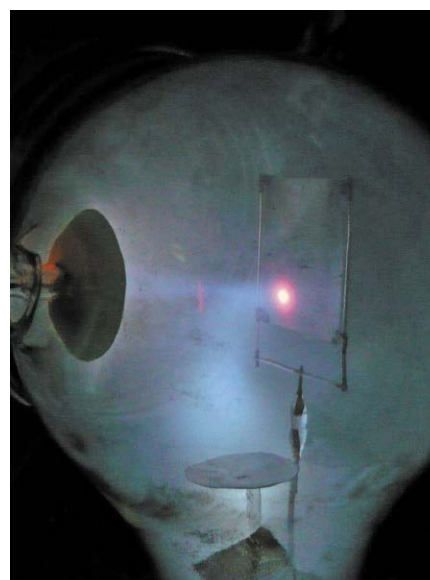
Fotografia 3. Lampa do pokazu zjawiska grzania cienkiej folii molibdenowej za pomocą promieni katodowych. Widoczny jest bieg pierwotnej i wtórnej wiązki elektronowej, które jonizują gaz świecący na niebiesko.
