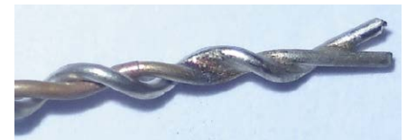
Fotografia 12. Elektronowy spaw drutu miedziopłaszczyznowego z niklowym. Druty o średnicy 0,5 mm
