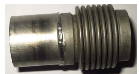
Fotografia 15. Elektronowy spaw detali ze stali nierdzewnej.
