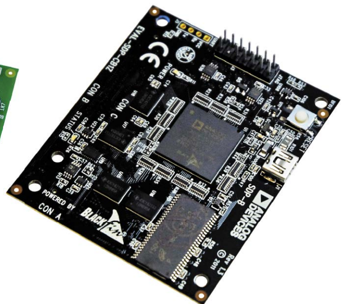
Fotografia 3. Platforma uruchomieniowa SDP-CB1Z
