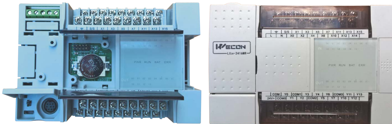
Fotografia 2. Wygląd sterownika LX3V-1412MR-A po zdemontowaniu kłapek
