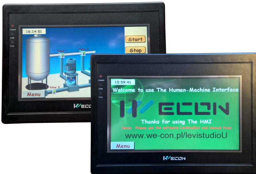
Fotografia 4. Panel HMI Wecon Levi 700EL
