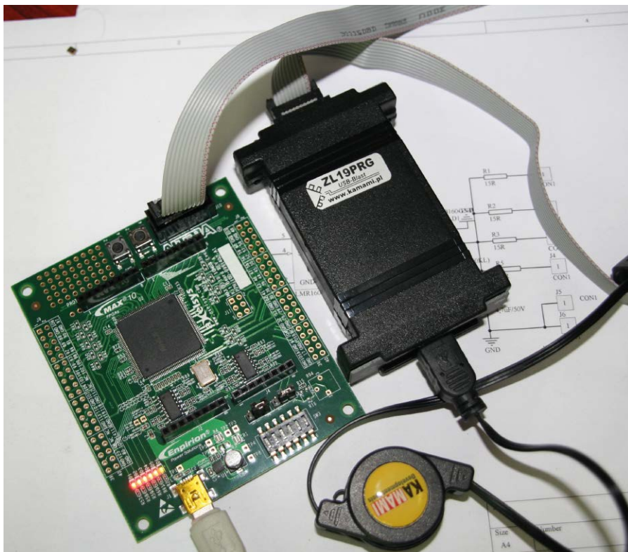
Fotografia 5. Chętni do poznania możliwości układów MAX10 muszą wyposażyć się w programator-konfigurator JTAG zgodny ze standardem USB/Byte Blaster – jednym z najtańszych dostępnych na rynku jest interfejs ZL19PRG
