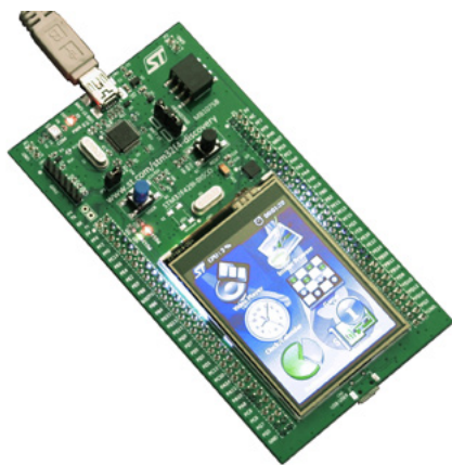
Fotografia 1. Zestaw DISCOVERY z mikrokontrolerem STM32F429 wyposażono w kolorowy wyświetlacz LCD z touch-panelem
