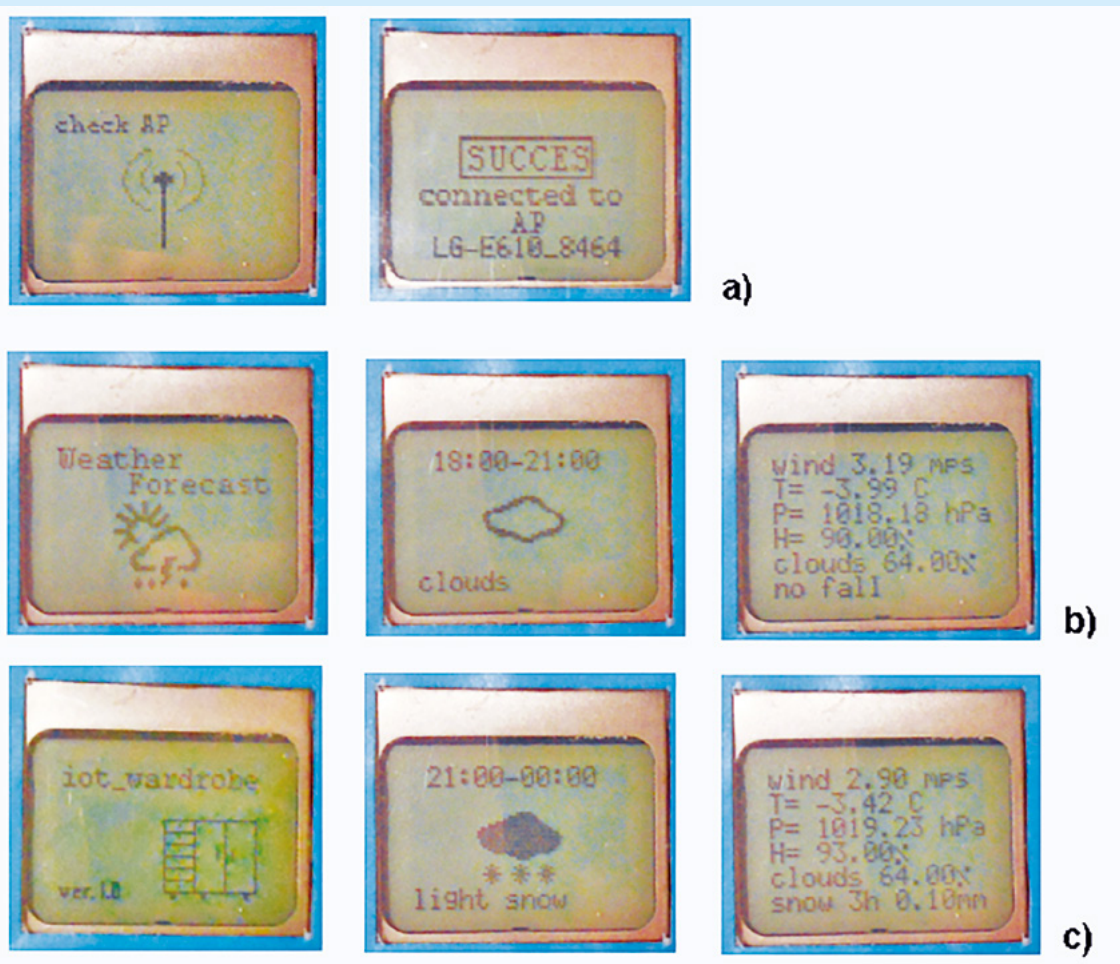
Fotografia 4. Sterownik podczas pracy w trybach: a) check access point, b) normal work, c) info screen
