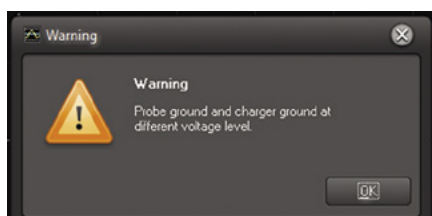
Rysunek 3. Ostrzeżenie przed różnymi potencjałami mas komputera i dołączonego do niego urządzenia
