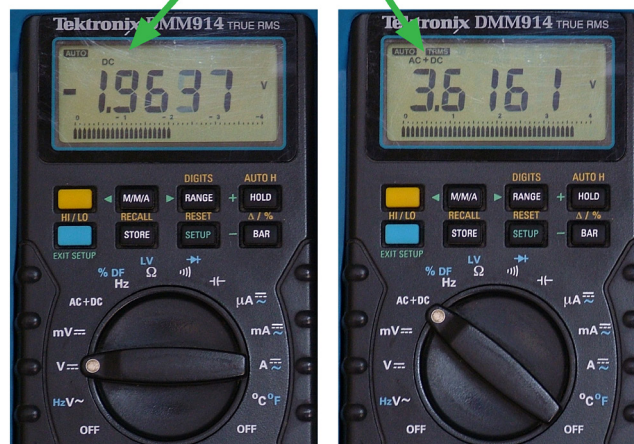
Rysunek 4. Pomiary napięcia średniego i skutecznego DCRMS przebiegu testowego wykonane oscyloskopem DS1202CA i multimetrem DMM914
