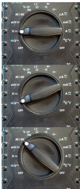
Rysunek 2. Ustawienie przełącznika rodzaju pomiaru dla: a) napięcia DC (wartości średniej przebiegu zmiennego), b) napięcia AC (wartości skutecznej ACRMS – bez składowej stałej), c) napięcia AC+DC (wartości skutecznej DCRMS – z uwzględnieniem składowej stałej)
