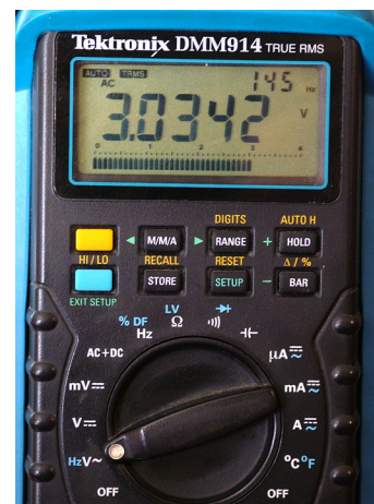
Fotografia 7. Pomiar napięcia skutecznego ACRMS przebiegu testowego wykonany multimetrem DMM914
