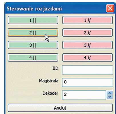
Rysunek 7. Oprogramowanie Rocrail – ekran sterowania rozjazdami
