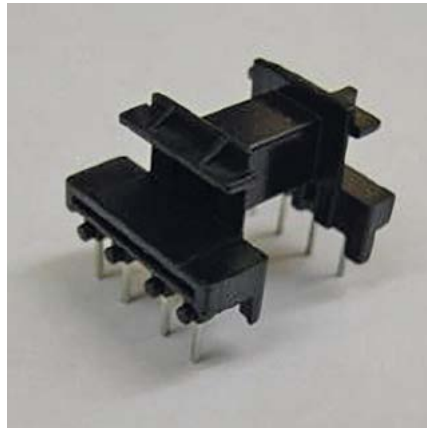
Fotografia 4. Bezpieczny karkas EF16 – widoczny zwiększony odstęp pinów strony wtórnej od uzwojeń i rdzenia:
