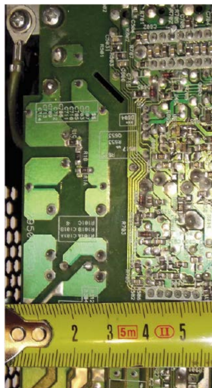
Fotografia 2. Odstępy izolacyjne pomiędzy stroną pierwotną a wtórną na PCB zasilacza komputerowego
