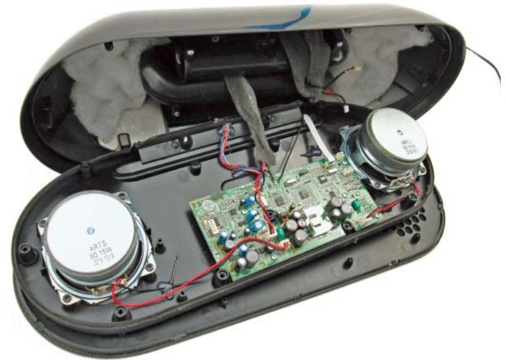
Fotografia 3. Po odkręceniu śrub mocujących podstawę panelu czołowego uzyskujemy dostęp do głośników i płytki głównej stacji dokującej
