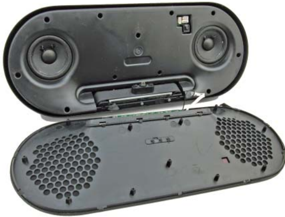
Fotografia 1. Po zdjęciu panelu uzyskujemy dostęp do wkrętów mocujących go do korpusu obudowy oraz odbiornika podczerwieni
