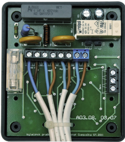
Fotografia 4. Wygląd zmontowanego wyłącznika w widoku od góry
