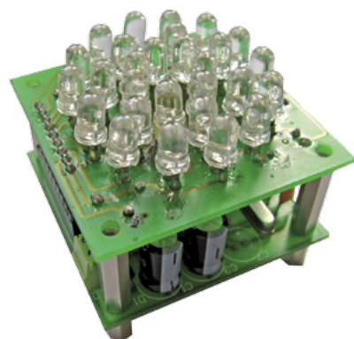
Fotografia 5. Wyglądu modułu LED – okręgi
