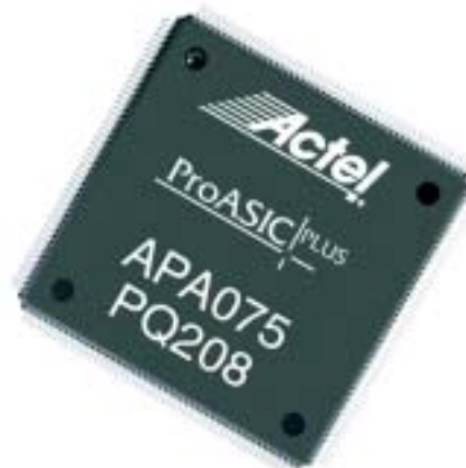
Fot. 2. Wygląd układu APA075 w obudowie TQFP208
