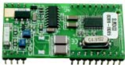
Fot. 3. Zewnętrzne wymiary DIP-modemu odpowiadają klasycznym obudowom
