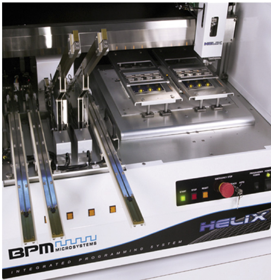
Rysunek 6. Automat HELIX – widok podajników układów z tub, głowicy „pick & place” oraz 2 site’ów
