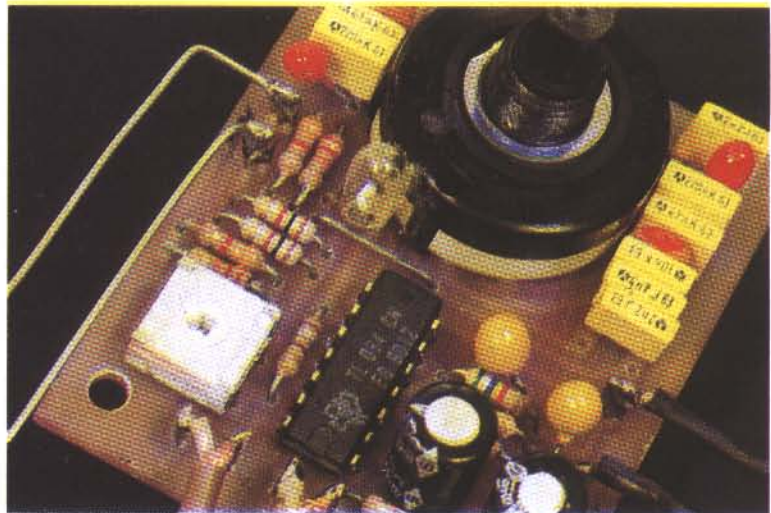
Płytkę generatora, widoczna żaróweczka na wejściu odwracającym TL084.
