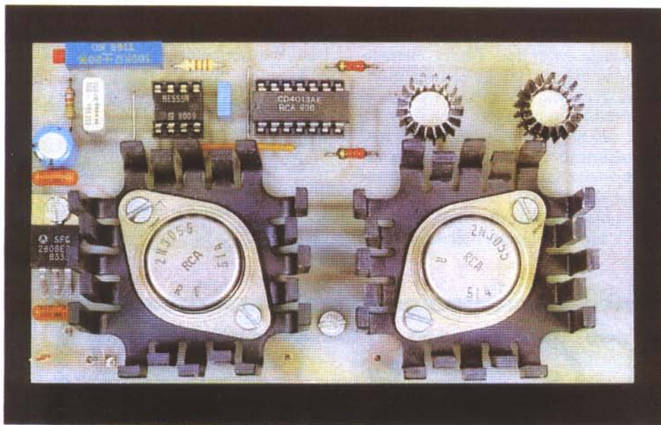
Fot.2. Widok płytki przetwornicy. Tranzystory mocy zamontowane są na radiatorach.
