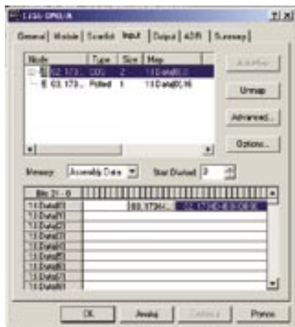
Rys. 7. Wejścia modułu zdalnego zamapowane na wejścia sterownika
